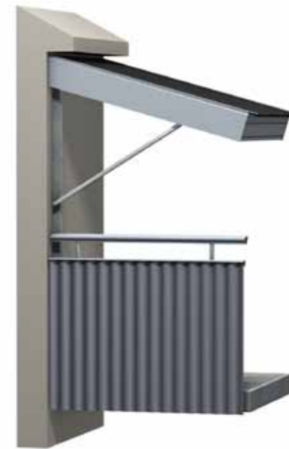
Standardtag med trykstang, som forankres i stålperle.
