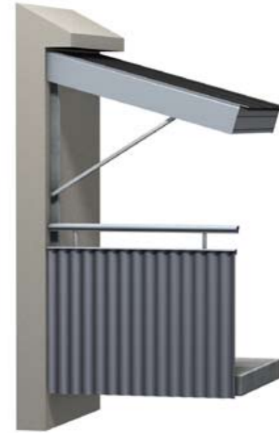
Standardtag med trykstang, som forankres i stålillerne.
