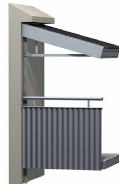
Konsolltak med direkte innfesting i stål stolpene.
