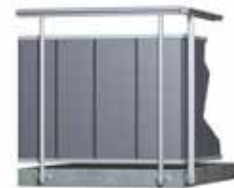
Innvendig bekledding med synlige stolper og synlig plate.
