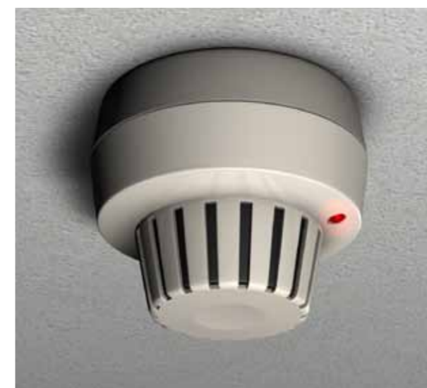
RÖKDETEKTOR Vid en eventuell rökutveckling skickas signaler från den takmonterade rökdetektorn till en elektromagnet som sitter vid respektive lucksektion.
