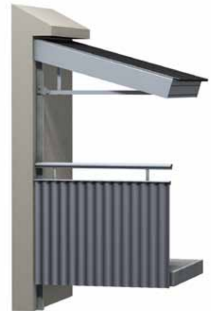
Konsoltak med direkt infästning i ståpelarna.
