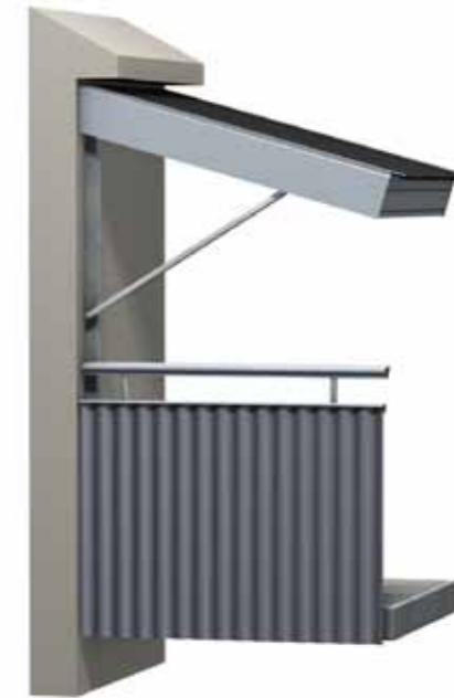
Standardtak med tryckstag som förankras i ståpelarna.
